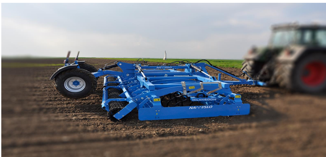
Rysunek 2. Kompaktor do upraw przedsiewnych 4m w pozycji roboczej.
